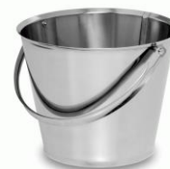
Figura 10 – Balde para colheita indirecta de amostras.
